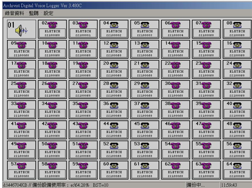
VLR 系統的主畫面是由標示軌道編號的方格及狀態圖案所組成。每一含有圖案的方格代表已安裝的軌道，未完成安裝的軌道其方格內為空白。上圖顯示的畫面為全部 64 軌均已安裝的 VLR-164 系統主畫面，其中 01 方格的喇叭圖案代表系統的放音專用軌道，02 方格則代表系統的異常通知與電話查詢軌道(此為選項功能)。03 以後方格則保留給錄音使用，且均以電話圖案代表。
