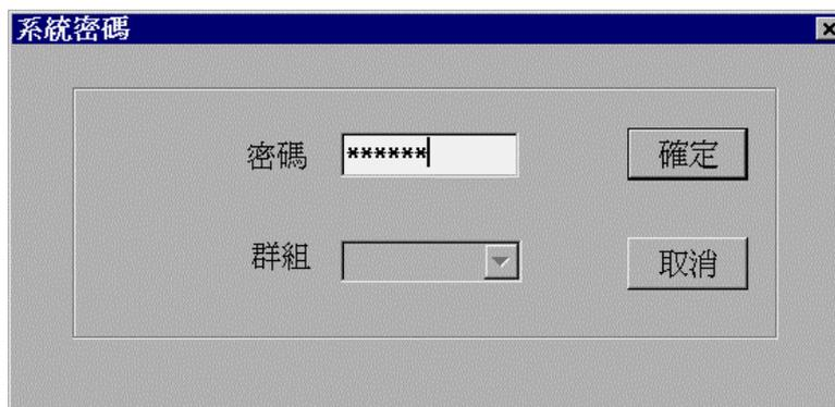
本圖顯示系統密碼的設定或更改方式。除上層的管理者密碼外，VLR 系統亦具備群組及群組密碼之設定功能，利用系統群組設定功能可將系統軌道分割為若干群分屬不同部門以利管理，並建立各群組獨立之密碼。
